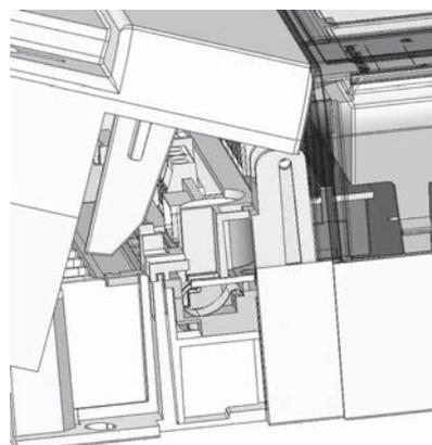
При снятии крышки зажимов срабатывает датчик фиксации снятия крышки зажимов, обеспечивающий регистрацию события на индикаторе и в памяти счётчика.
