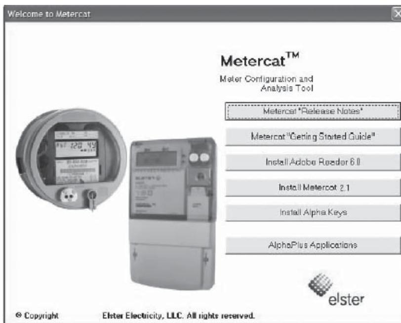
Для параметризации счётчиков Альфа А1800 и чтения коммерческих и диагностических данных используется программный конфигуратор Metercat, работающий под управлением ОС Windows NT, 2000, XP, Win7, Win8.
